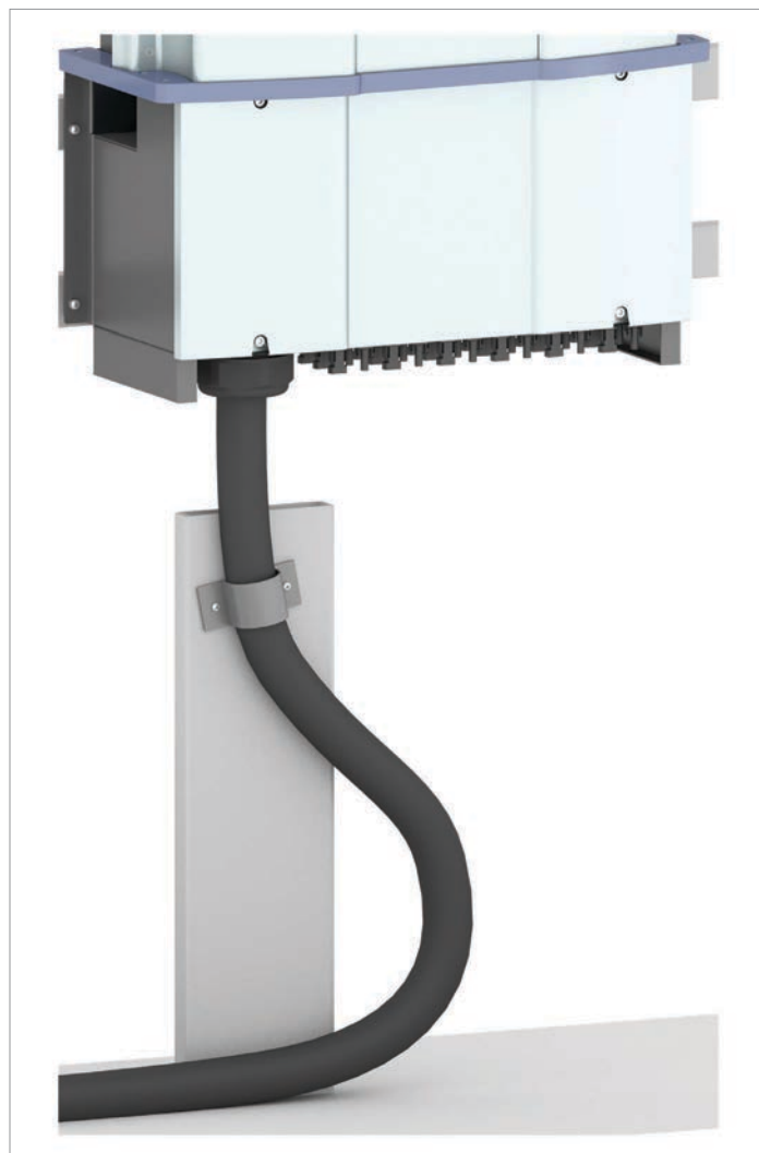
Amenée recommandée du câble AC pour le M88H_122 (CF)
