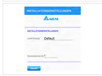
6. Pour enregistrer les réglages de l'installation, appuyer sur le bouton **Set (prendre en charge)**.
