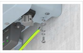
Fixer le câble de mise à la terre sur l'onduleur. Un écrou, une rondelle à ressort, une rondelle plate et une rondelle dentée sont déjà montées sur l'onduleur.
